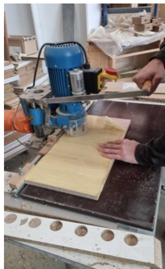
Perçage des charnières
